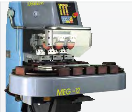
Convogliatore MEG 12 su Logica 125 Conveyor MEG 12 fixed on Logica 125
