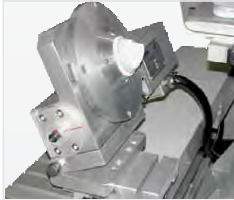
Tavola rotante TRCN 2.5 come 4° asse di rotazione su indexore PR 610 TRCN 2.5 rotary table working as 4° axes fixed on indexer PR 610
