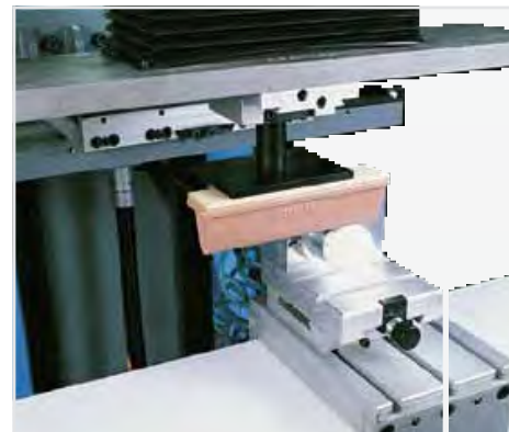
Indexore PS 460 per stampa a rotolamento su Logica 150 Indexer PS 460 for rolling printing system fixed on Logica 150
