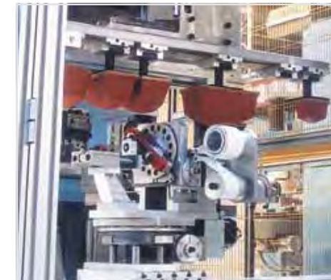
Dispositivo multiasse (TRCN 2.5 + TRCN 03) su indexore PRE 1370 Multiaxis device (TRCN 2.5 + TRCN 03) on indexer PRE 1370
