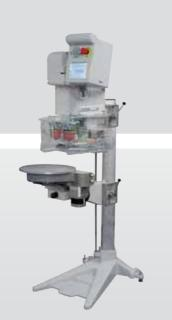
elettrico a controllo numerico 770 N regolabile fino a 5000 c/h (\*) 1 - 2 fino a 2 da 90 mm 102 mm 90 mm - 57 mm (con reciprocatore tamponi) 220/240 V - monofase - 50/60 Hz circa 100 W (modello base) circa 50 Kg (modello base) 443x590x743 (h) mm (modello base) electric with numerical control adjustable up to 5000 c/h (\*) 1 - 2 up to 2 dia. 90 mm 102 mm
